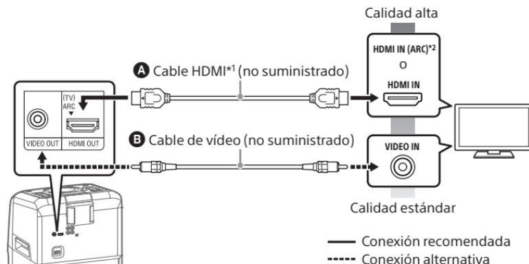
\*1 Cable HDMI de alta velocidad con Ethernet
