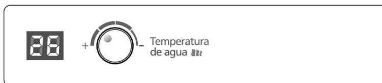
Algunos modelos vienen equipados con 2 perillas: Temperatura de agua y regulador de gas. Gire la perilla regulador de gas para modificar la temperatura del agua modificando el flujo de gas.
