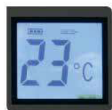
Display digital 1. Indica temperatura de salida del agua. 2. Indicador de falla por montaje inadecuado del ducto de evacuación.
