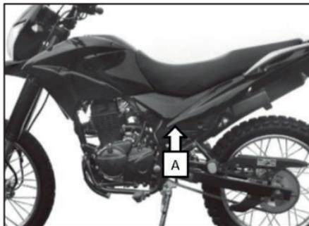
La bujía está al lado derecho del motor, para acceder a la bujía, retire el capuchón y utilice la copa de la bujía para desatornillarla.
