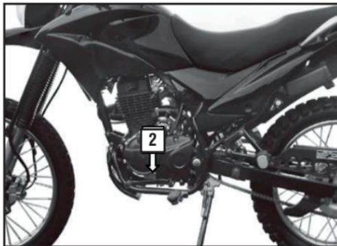
2. El número del motor se encuentra ubicado en el lado izquierdo del Vehículo, debajo de la cubierta del motor.
